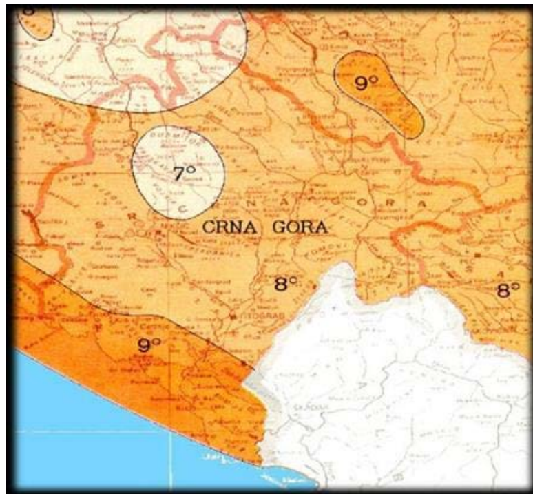
Slika br. 3 Privremena seizmološka karta teritorije SFRJ (dio za Crnu Goru) sa elementima očekivanog maksimalnog intenziteta zemljotresa, za povratni period od 500 godina
