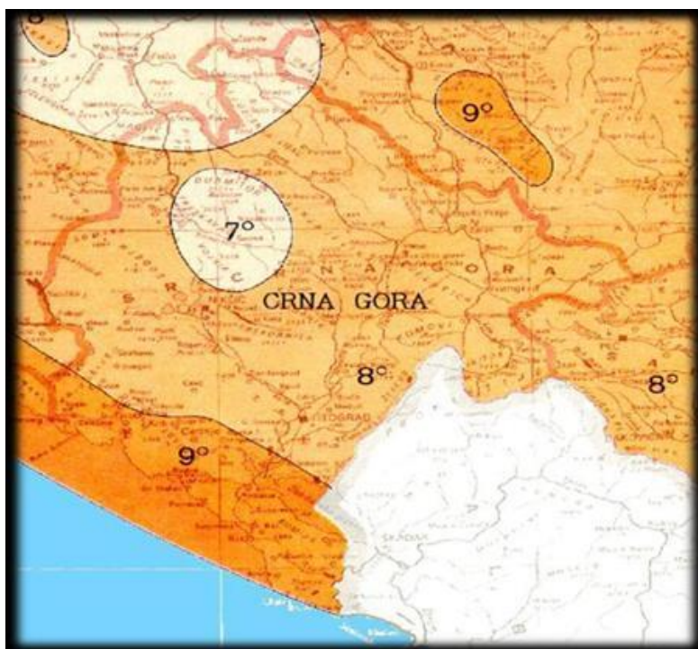
Slika br. 1 Privremena seizmološka karta teritorije SFRJ (dio za Crnu Goru) sa elementima očekivanog maksimalnog intenziteta zemljotresa, za povratni period od 500 godina (1987.godina)
