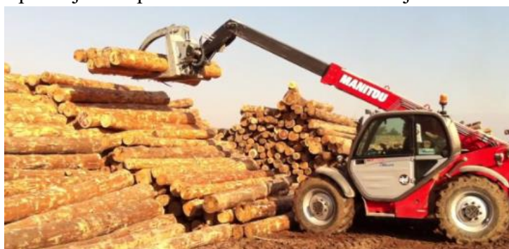
Ilustracija-Teleskopski utovarivač Manitou sa grajferom za trupce
