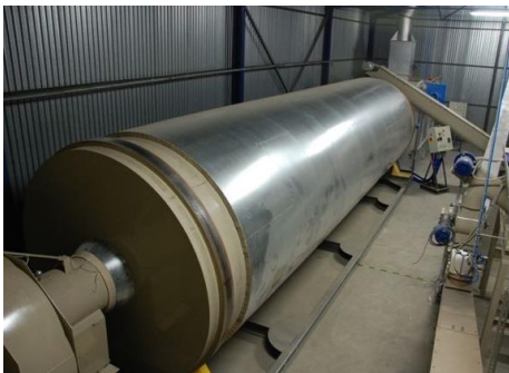
Ilustracija- Rotaciona sušara (Izvor: VALEX.hr)
